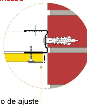
•El perfil Ángulo de Ajuste o Buña Z de ajuste podrá fijarse con tornillos T2 colocados con una separación de 15cm o con adhesivo de contacto. Luego recibirá dos manos de masilla SC Durlock®.
