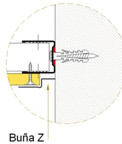
•El perfil Ángulo de Ajuste o Buña Z de ajuste podrá fijarse con tornillos T2 colocados con una separación de 15cm o con adhesivo de contacto. Luego recibirá dos manos de masilla SC Durlock®.
