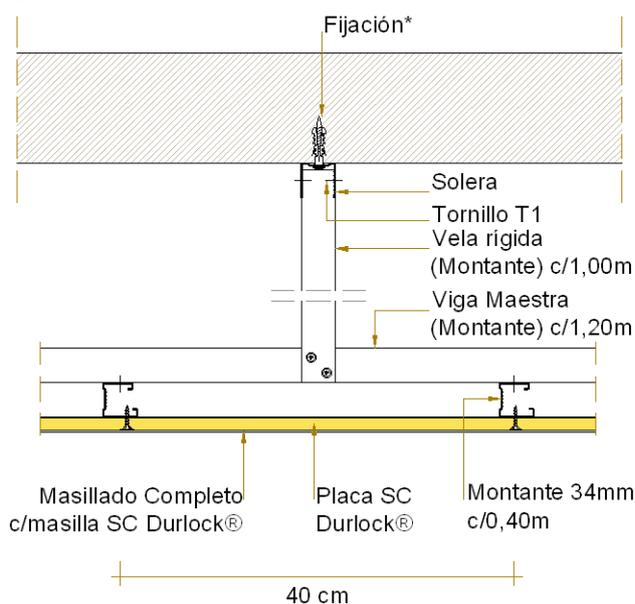
Cielorraso para semicubiertos, compuesto por una estructura metálica de perfiles Soleras y Montantes, a la cual se atornilla una capa de placas SC Durlock®. La estructura de perfiles para el sistema SC puede variar según el tipo de obra y su ubicación geográfica.
